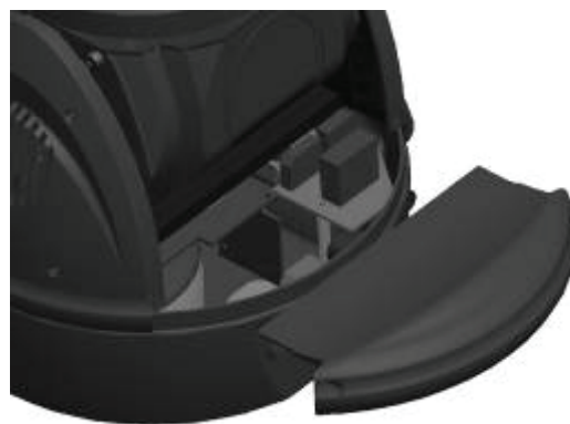
Figura 4. Extracción de las tapas de acceso a la base para limpiar y comprobar la correa del eje X.
